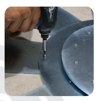
Montieren Sie die acht inneren Bögen (B-Teile) zwischen den Aussparungen der Arme mit Hilfe der Innenplatten und den mitgelieferten Kreuzschlitzschrauben.
