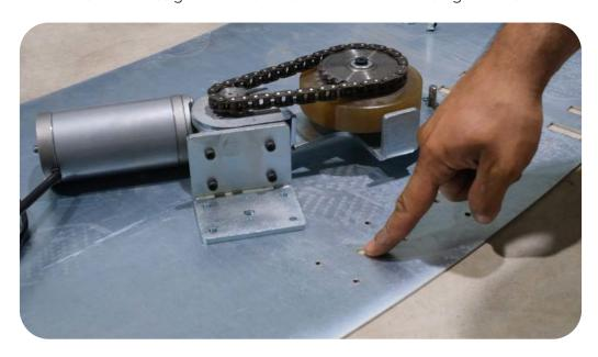
Befestigen Sie schließlich die Anschläge an den vorgesehenen Stellen des äußeren Bogens mit 4 BTR-Schrauben.
